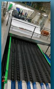
CALIBRADOR CON VISIÓN ARTIFICIAL
